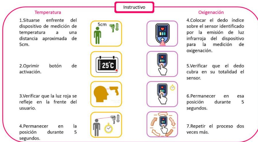
**Fig. 6.** Instructivo con los pasos que se siguen para realizar la medición de la temperatura y la oxigenación del usuario, en el proyecto planteado.
